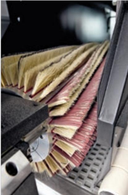
Robusta ed affidabile, la **spazzola longitudinale** è dotata del sistema di oscillazione trasversale per uniformare la qualità di finitura sul manufatto e di regolazione di interferenza elettronica azionabile da quadro comandi. Le setole abrasive sono sostituibili con rapidità senza la necessità di estrarre il gruppo dalla macchina. Spazzola ad inserti abrasivi di diametro 300 o 400 mm.
