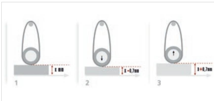
Il **gruppo Rullo con tecnologia HP (High Performance)**, permette di lavorare pannelli con differenze di spessore senza per questo dover variare la quota di lavoro. Tale soluzione riduce i tempi di settaggio macchina e garantisce finitura costante anche su lotti di pannelli con differenze di spessore sino a 1,4 mm.
