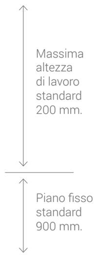
La soluzione standard **Testa Mobile** offre **altezza di lavoro standard fino a 200 mm lavorabili pur mantenendo l'altezza del piano di lavoro a 900 mm da terra.**
